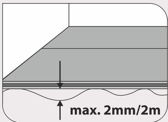
**4.7** При проверке выравнивающего слоя контрольным 2-метровым правилом, передвигаемым во всех направлениях, необходимо проводить не менее девяти измерений на каждые 50 – 70 м<sup>2</sup>. Отклонение поверхности выравнивающего слоя от плоскости **не должны превышать 2 мм.**
