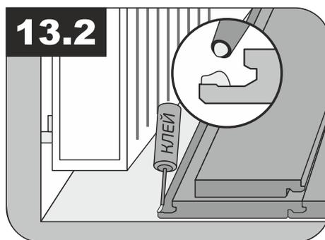
Сдвиньте плашки кварцевого ламината под выступающую помеху и, плотно прижав, соедините с плашками предыдущего ряда.
