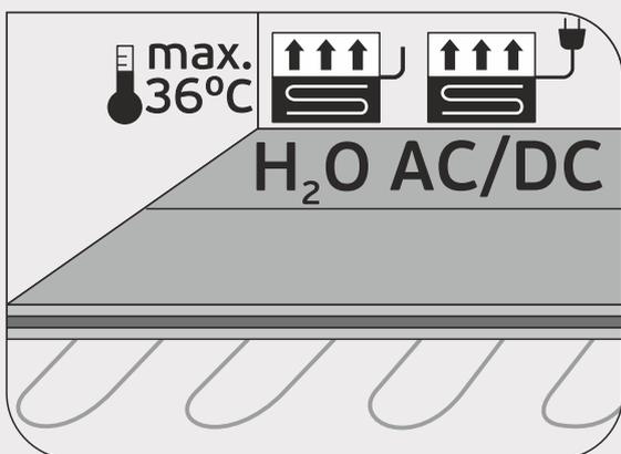
При укладке SPC-покрытия высокой плотности (кварцевого ламината Home Expert) на подогреваемые полы систему нужно отключить за 3-4 суток до начала укладки и включить после завершения всех работ по монтажу напольного покрытия.
