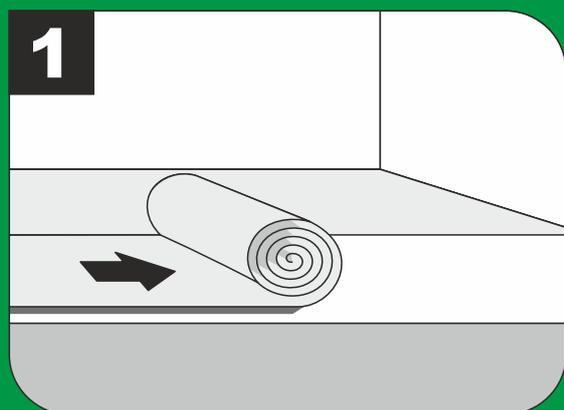
**7.1** Для обеспечения комфорта при эксплуатации расстилается плотная подложка толщиной 1,5 мм. Подложка укладывается встык и закрепляется при помощи клейкой ленты по всей длине стыка.
